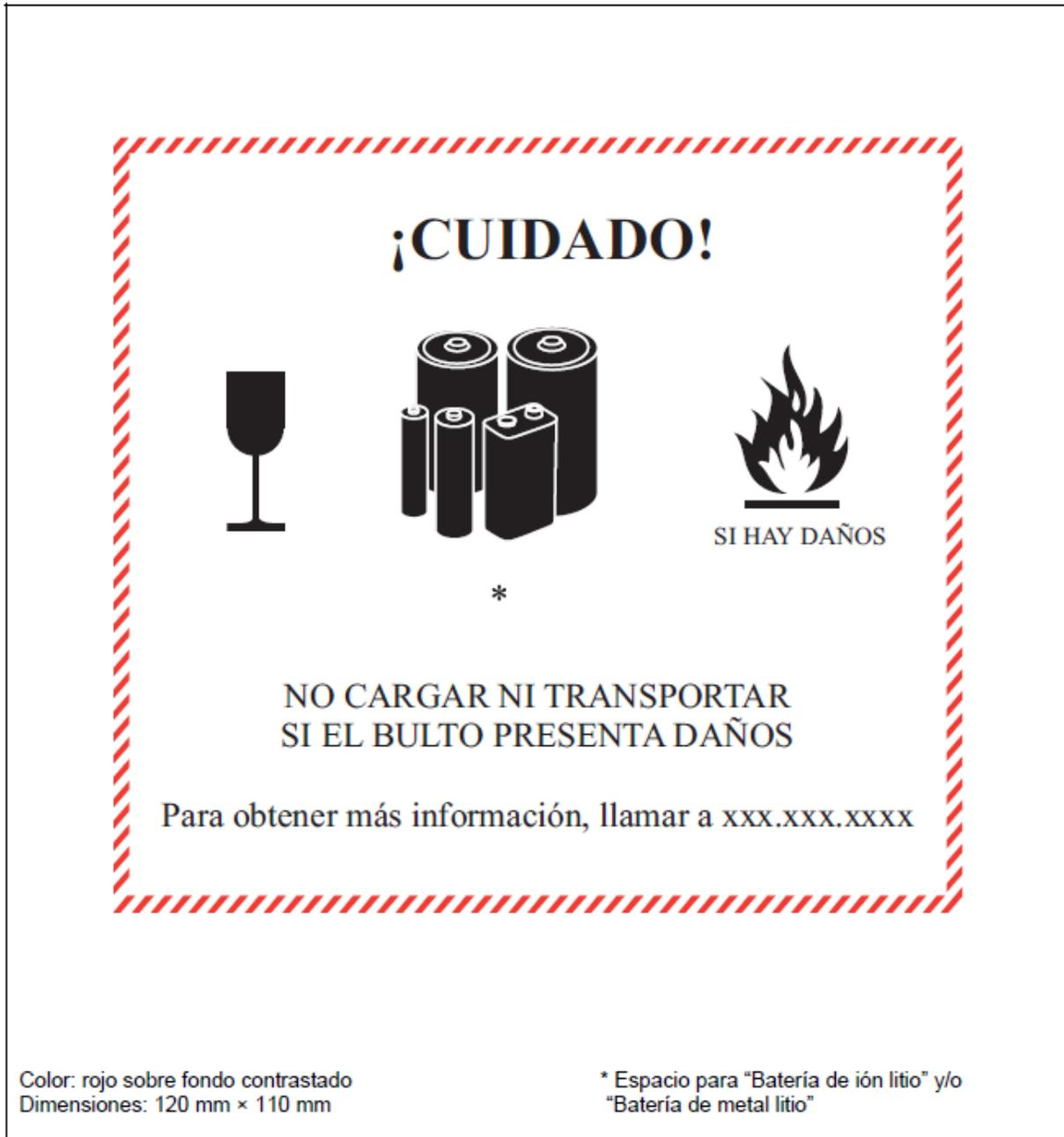
Figura 6.29. Etiqueta de manipulación de baterías de litio
