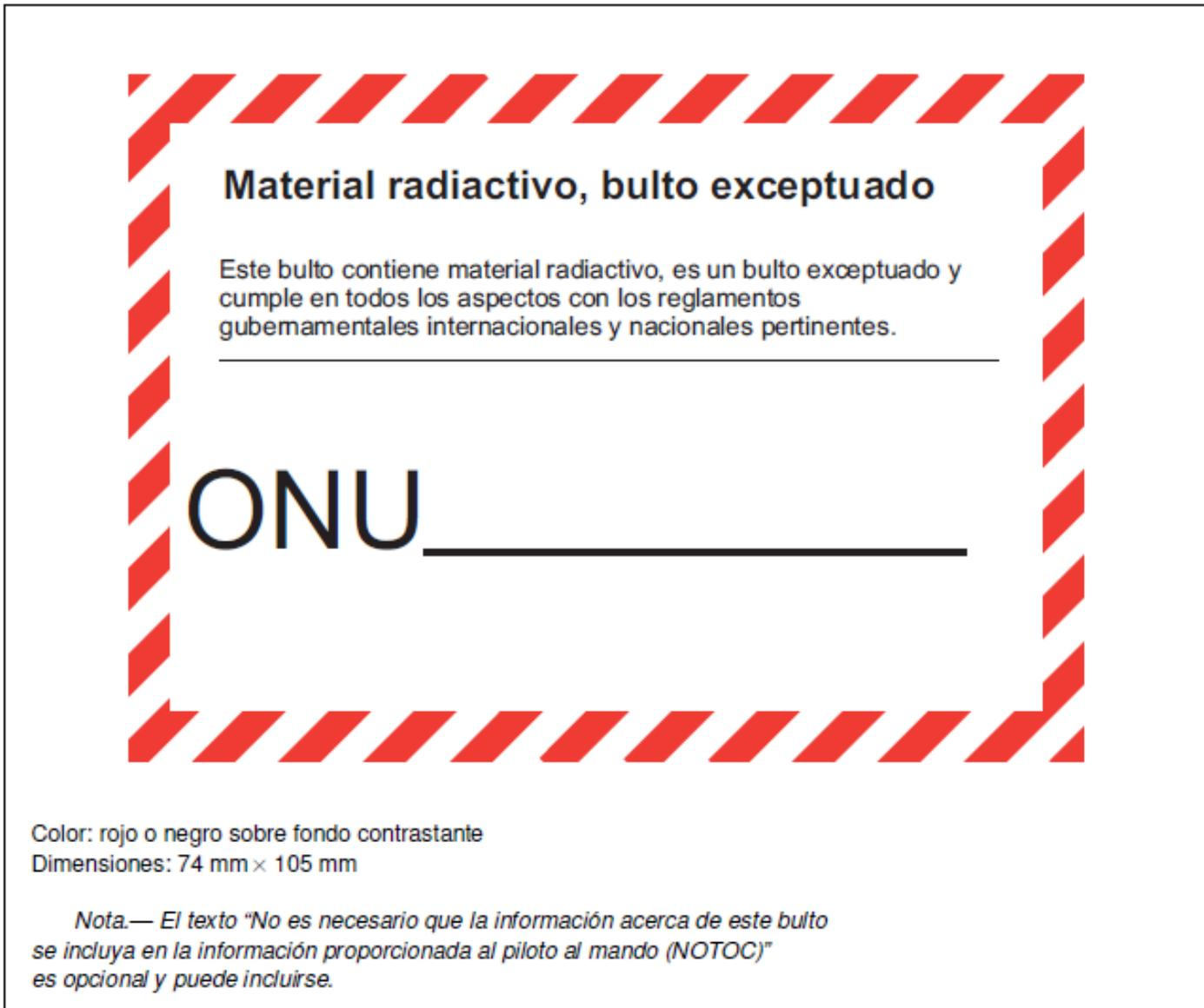
Figura 6.28. Material radioactivo, bulto exceptuado
